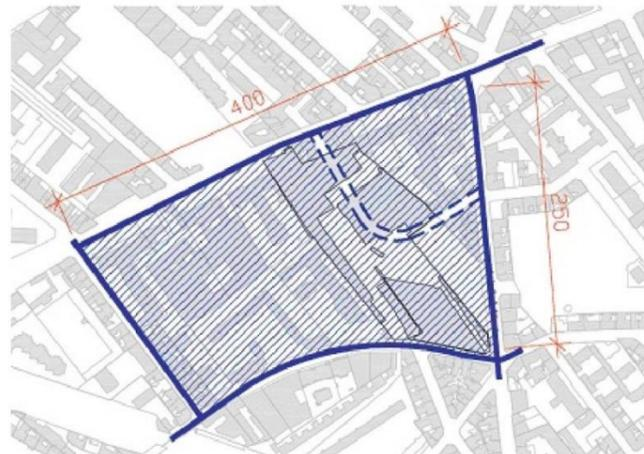
Figure 3 : Schématisation de la création de la voie nouvelle au sein de l'îlot (source : étude d'impact)
